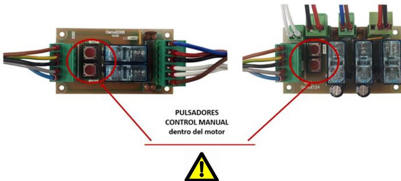
**IMPORTANTE:** el Circuito Control Manual **SOLO** se usa cuando el regulador bloquea el sistema y no podemos resolver el problema temporalmente.
