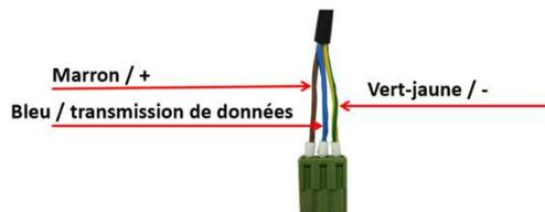
**Dans les nouvelles installations mettre les sondes à câble blindé** pour éviter les perturbations radioélectriques affectant la qualité des signaux transmis.
