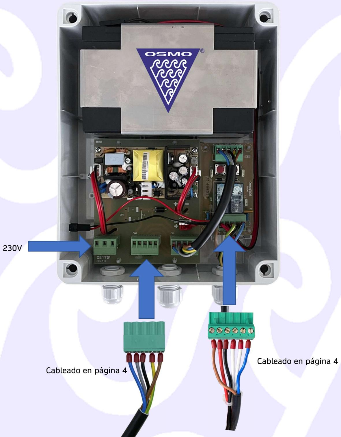
Si el sentido de giro no coincide con las órdenes del ordenador, habrá que cambiar el orden de los cables del motor.
