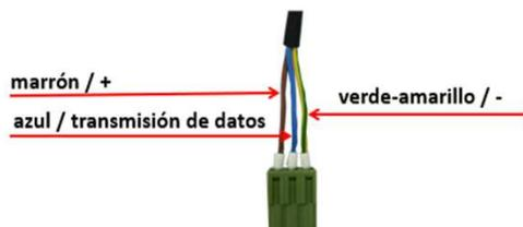
**En las instalaciones nuevas poner las sondas con cable apantallado** para evitar perturbaciones radioeléctricas que afectan a la calidad de las señales transmitidas.
